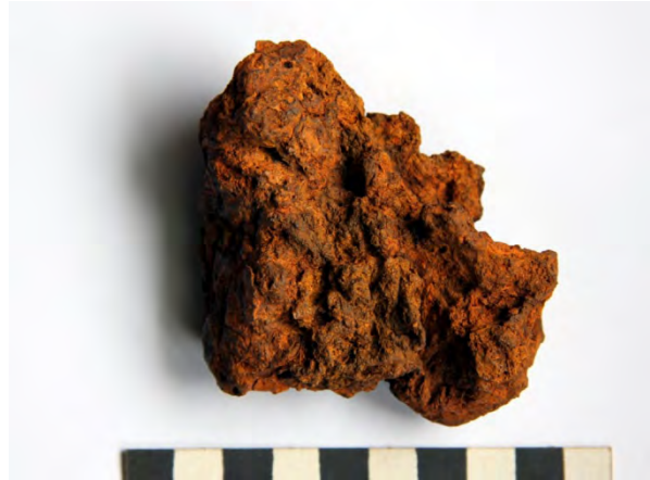
Afbeelding 17 bovenzijde van ijzerrijke smeedslak Vondstnummer 8.1 na het verwijderen van de roestlaag. De schaalverdeling is in cm.
