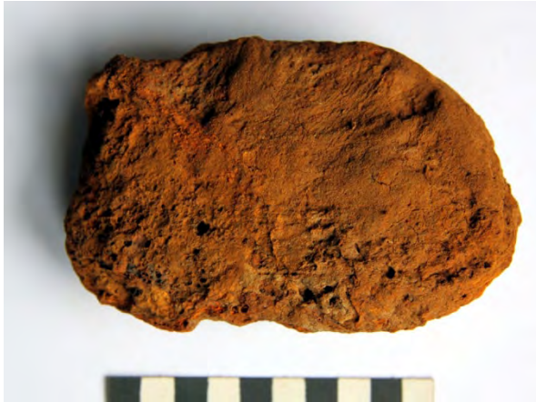
Afbeelding 16 ijzerrijke smeedslak Vondstnummer 8.6 bedekt met een dikke roestige laag. De schaalverdeling is in cm.
